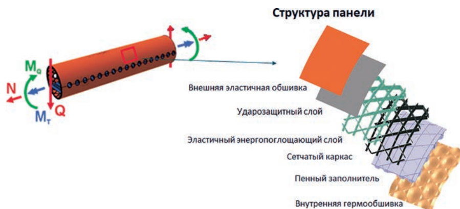
Рис. 1. Сетчатая композитная конструкция отсека носовой части фюзеляжа
