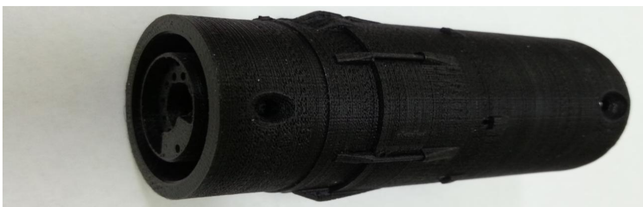
Рисунок 8 – Модель хвостовой части, распечатанная на FDM
