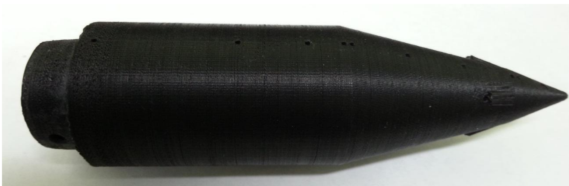
Рисунок 7 – Модель носовой части, распечатанная на FDM
