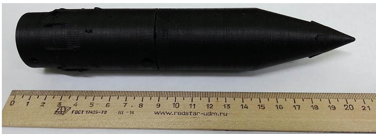
Рисунок 10 – Модель, распечатанная на FDM, в собранном состоянии
