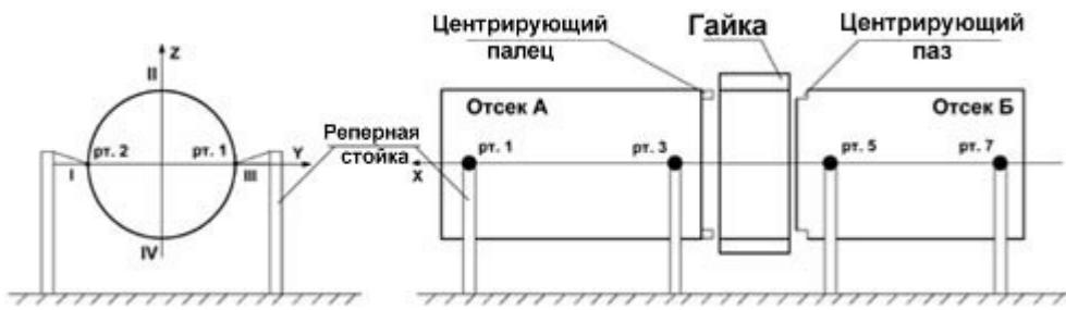
Рис. 3. Базирование отсеков по реперным точкам в стыковочном стенде.
