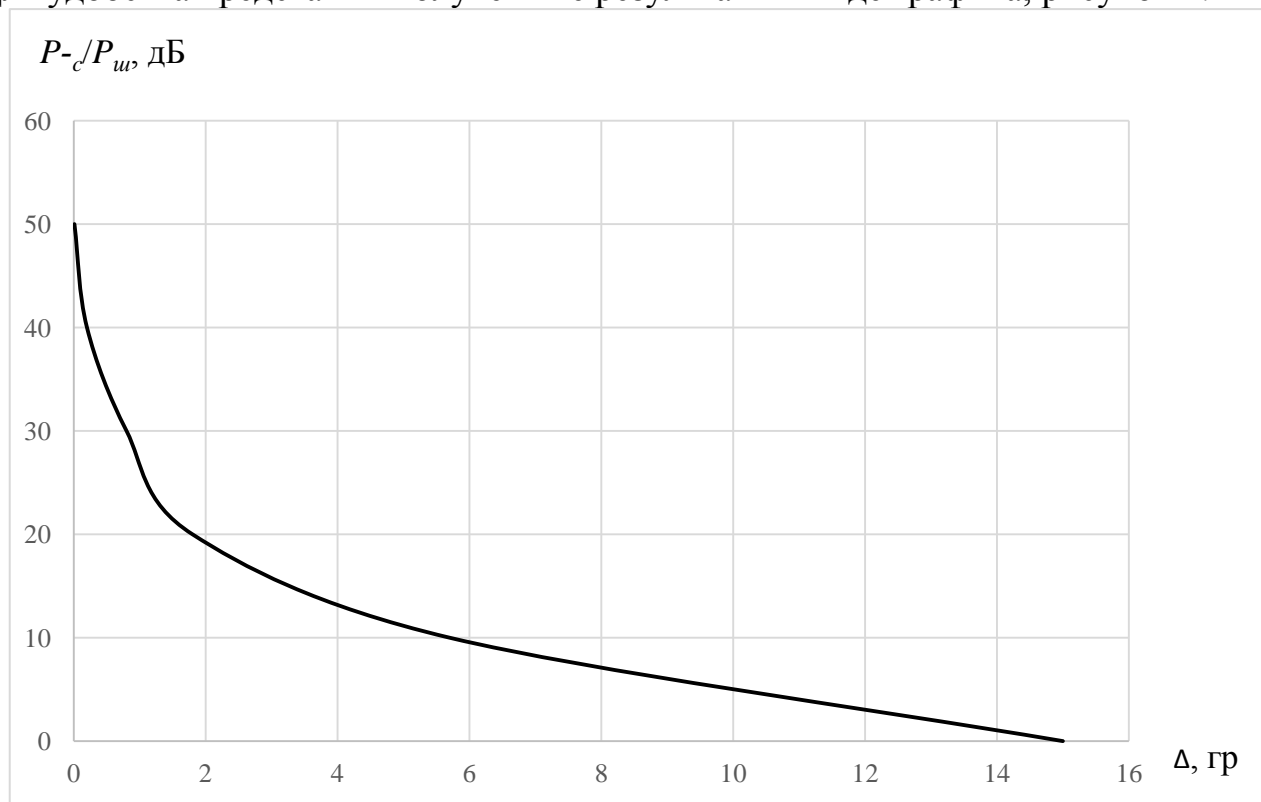
Рисунок 4 – Зависимость разрешающей способности от отношения сигнал/шум
