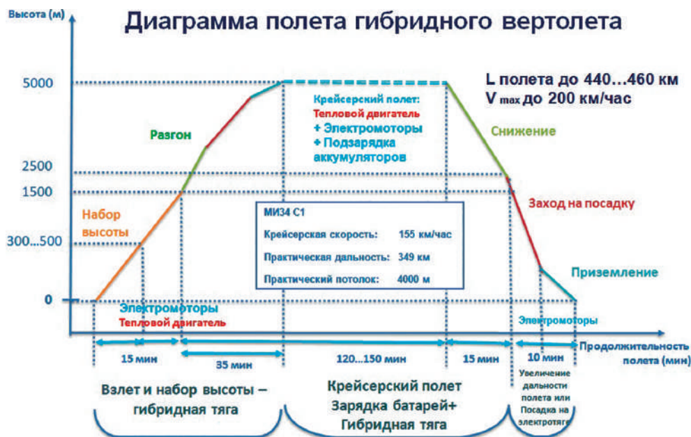
Рис. 5. Модельная диаграмма полета легкого вертолета с ГСУ
