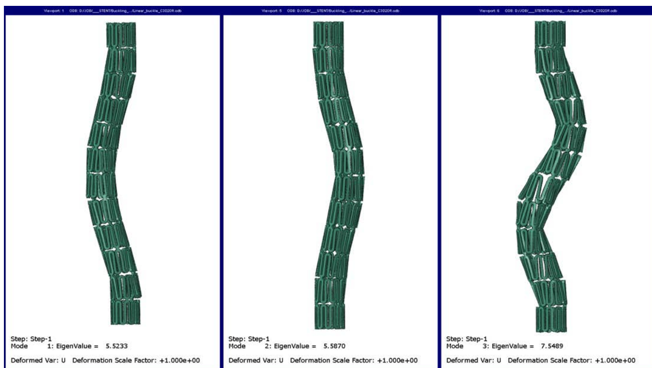
Рис. 8 Визуализация результатов, полученных в рамках линеаризованной постановки. Показаны первые три формы колебаний и собственные значения
