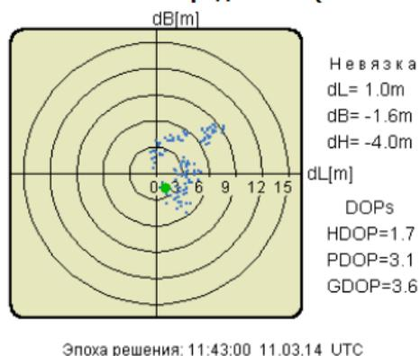
Рисунок 3. Мониторинг точности РНП ГЛОНАСС в ИАЦ КВНО [3].
