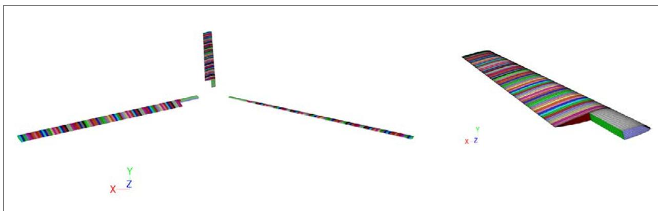
**Рис. 13.** Модель несущего винта, созданная для расчетов в пакете Ansys Fluent.
