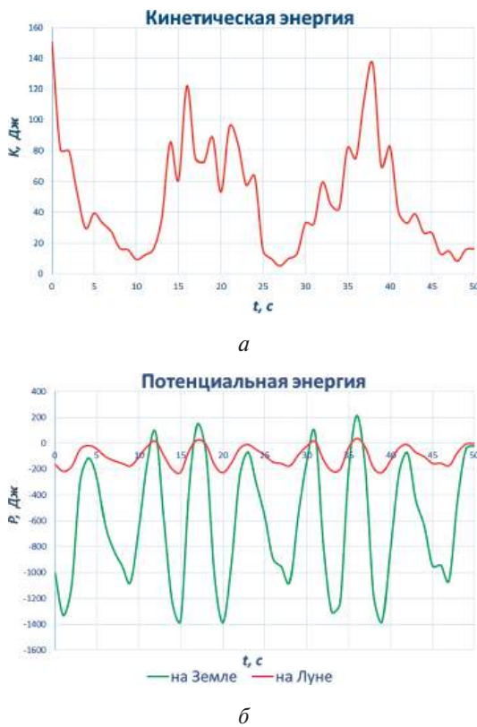
Рис. 8. Полная кинетическая и потенциальная энергия манипулятора, Дж: а – кинетическая энергия; б – потенциальная энергия
