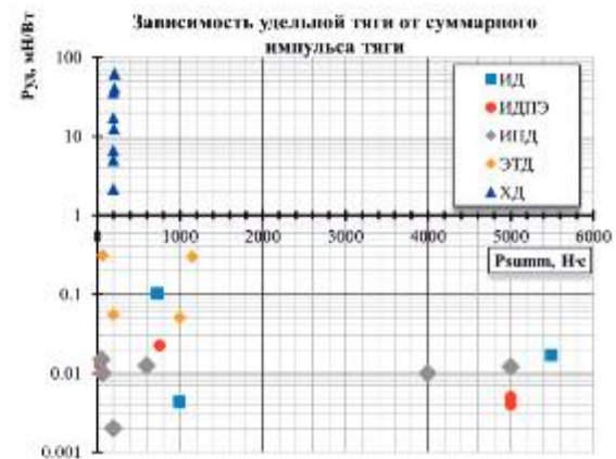
Рис. 3. Зависимость удельной тяги от суммарного импульса тяги для разработанных в мире реактивных двигательных установок объемом меньше 1,2U (ИД – ионные двигатели; ИДПЭ – ионные двигатели с полевой эмиссией, ИПД – импульсные плазменные двигатели, ЭТД – электротермические двигатели, ХД – химические двигатели)
