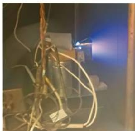
Рис. 7. Фотография АИПД во время работы
