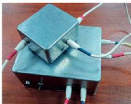
Рис. 6. Фотография лабораторных образцов СПУ (снизу) и БИР (сверху) для АИПД с малой энергией разряда
