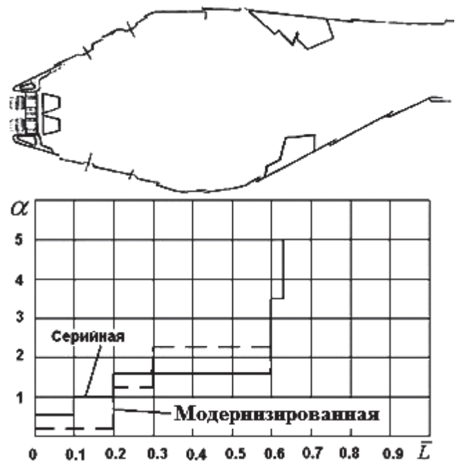
Рис. 9. Схема распределения коэффициента избытка воздуха по длине серийной и модернизированной камеры сгорания
