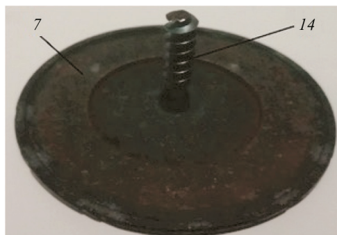
Рис. 10. Крышка газовой горелки для бытовых плит с интенсификатором теплоотдачи в виде металлического стержня с винтовым оребрением 14 на поверхности
