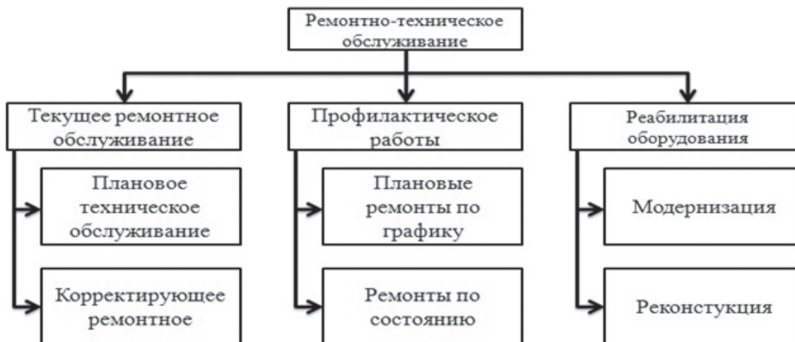
Рис. 6. Виды технического обслуживания и ремонтов
