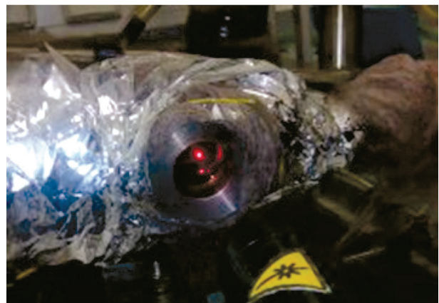
Рис. 5. Испарительная камера с оптическими окнами
