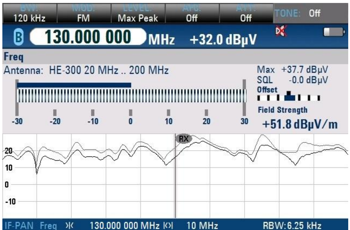
Рисунок 2. Спектрограмма зафиксированных промышленных радиопомех от ВЛЭП
