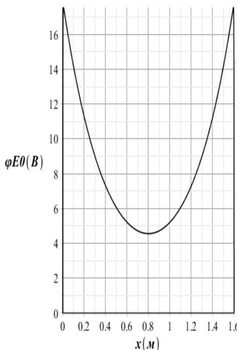
Рис4. Распределение электрического потенциала в оболочке на поверхности  $z=0$
