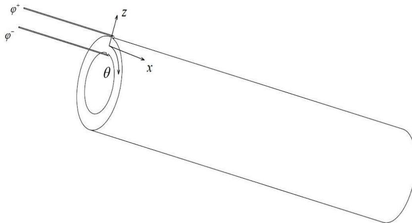
Рис 1. Цилиндрическая пьезоэлектрическая оболочка
