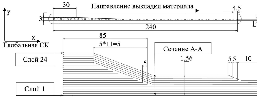
Рис. 1. Геометрические параметры (мм) и схема укладок композиционного материала конструктивно подобного гибкого элемента
