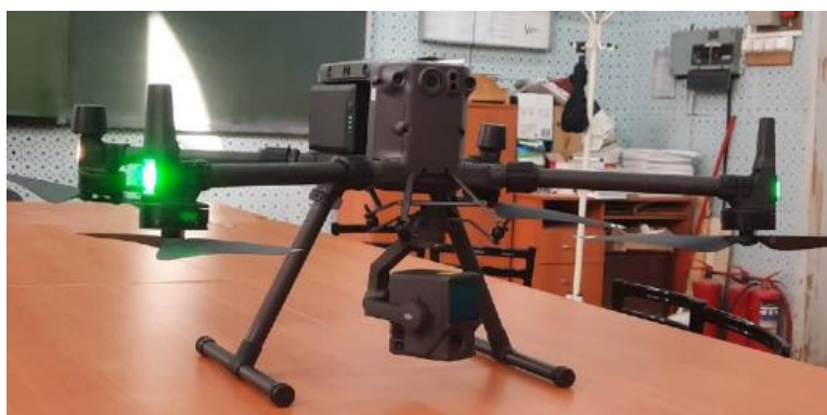
Рисунок 1 – БПЛА с установленной на нем МБЛС
