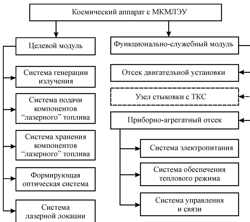
Рисунок 1 – Структурная схема КА с МКЛУ на борту.
