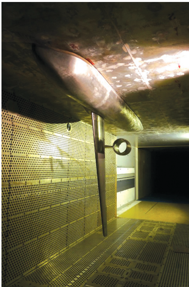
Рис. 8. Полумодель регионального самолёта в АДТ Т-128
