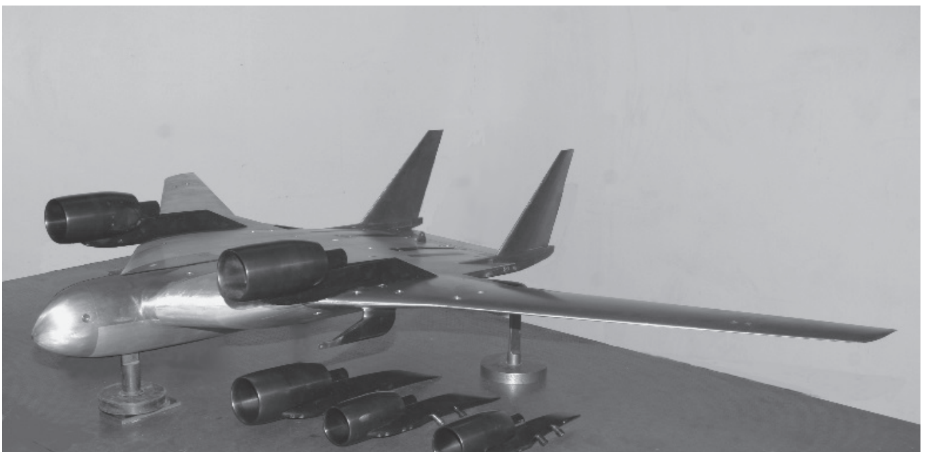
Рис. 3. Аэродинамическая модель «летающего крыла» с передним верхним положением мотогондол
