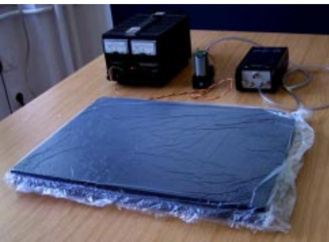
Рис. 1. Тестируемая панель пенополиуретана (длина — 340 мм, ширина — 340 мм, толщина — 30 мм). Сзади расположены источник питания, вакуумный насос и вакуумметр
