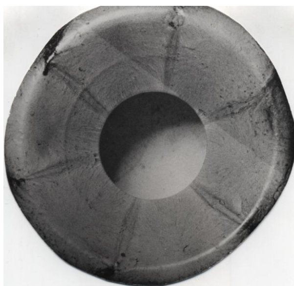
Рис. 5. Образование крупномасштабных продольных парных вихрей при взаимодействии плоских струй истекающих из лучей звездообразного проточного канала заряда ТТ с криволинейной поверхностью дозвуковой части утолщенного сопла.
