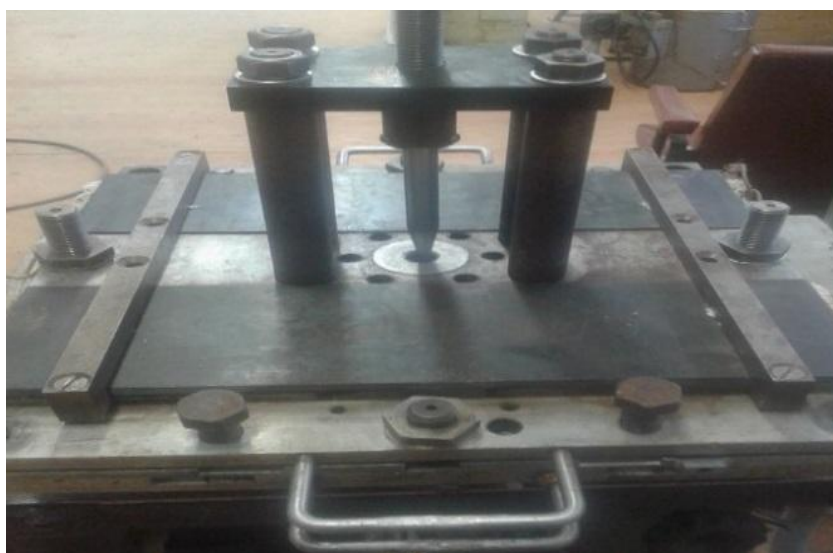
Рисунок 6 – Приспособление для изготовления пластин с проколотым отверстием
