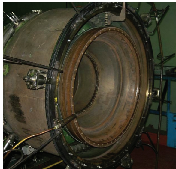
Рис. 5. Расположение газоотборного зонда на выходе из камеры сгорания
