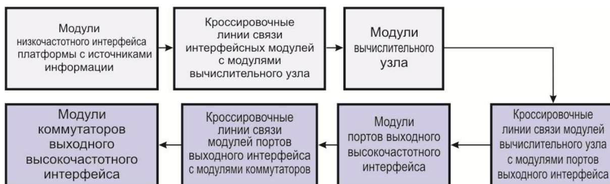
Рис. 2 Структурная схема типового интерфейсно вычислительного тракта.
