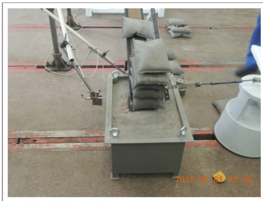
Рис. 7. Схема испытаний трапа на боковое перемещение в рыхлом грунте.
