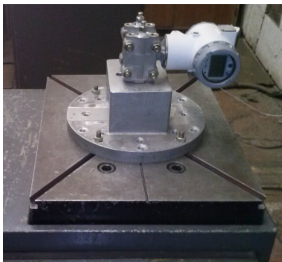
Рисунок 8. Датчик давления с дифференциально-емкостным первичным преобразователем, закрепленный на ударном стенде
